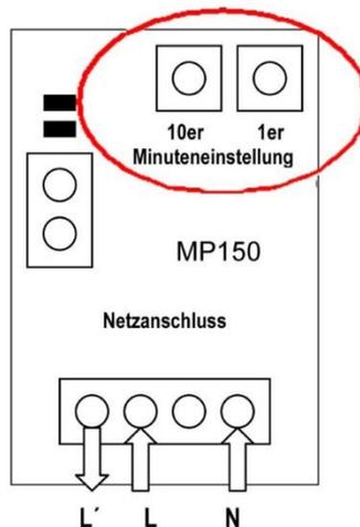
Die Zeit wird in Minuten auf der Platine eingestellt. Mit dem linken Schalter die Zehnerstelle, mit dem rechten Schalter die Einerstelle. Bei Mehrfacheinwurf wird die Zeit automatisch addiert.
