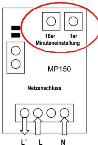
Die Zeit wird in Minuten eingestellt. Mit dem linken Schalter die Zehnerstelle, mit dem rechten Schalter die Einerstelle. Bei Mehrfacheinwurf wird die Zeit automatisch addiert. **4 5**
